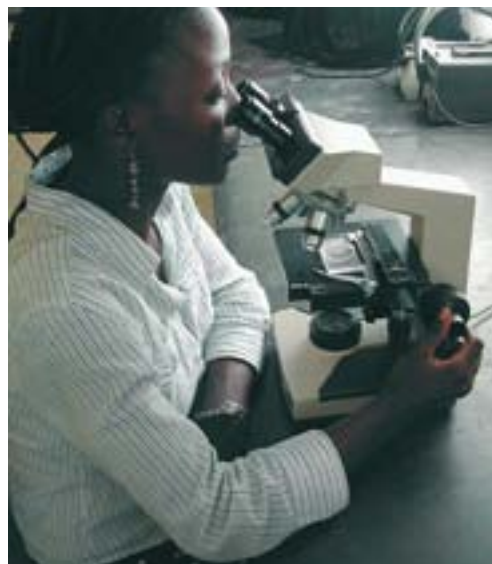
Utilisation d'un microscope avec un éclairage par le fond (diascopie).
