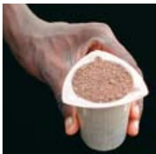
2. Mesure standardisée d'un certain volume d'échantillon, e.g. 100 ml.
