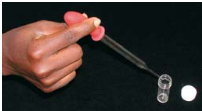
Pipetage de la solution de formaldéhyde dans une suspension de nématodes dans un tube de 7 ml afin de fixer l'échantillon.
