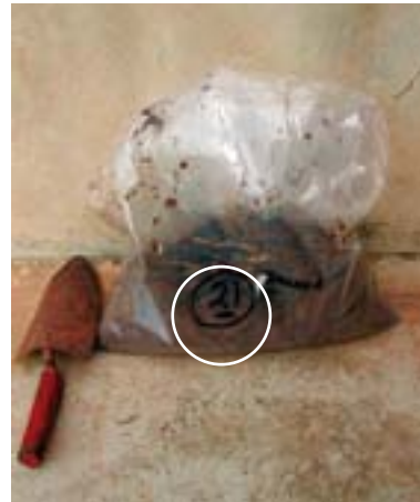
Étiquetage des échantillons avec un marqueur indélébile permanent.
