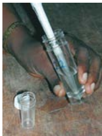
Figure 26. Méthode d'extraction par Baermann pour les échantillons de sol.
