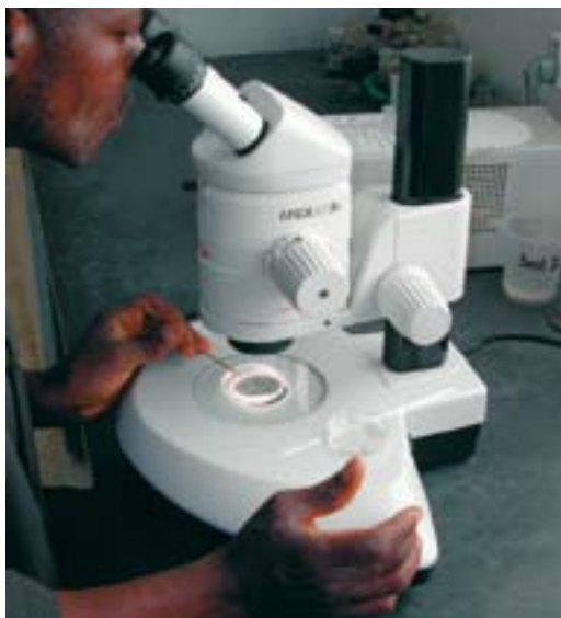
Utilisation d'une loupe binoculaire avec un éclairage par le fond (diascopie).
